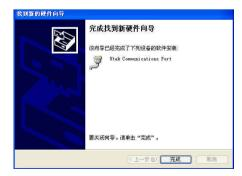
后面就按照上述步骤安装余下7个串口的驱动,即可 使用。 安装好驱动后打开设备管理器看一下在端口栏中有没有虚拟的COM口,如果系统之前没有安装过其它串口驱动,系统默认的COM口是COM3、4、5、6、7、8、9、10,如下图显示,到这里UT-728就完成所有的驱动程序的安装了。
